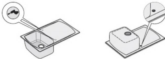
2. Um das Hahnloch in Ihrer Spüle zu erzeugen, nehmen Sie bitte eine Bohrkronenbohrer oder bohren Sie mit einem Metallbohrer (max. 4mm) mehrfach von unten in der Fräsnut der Spüle vor. Schlagen Sie dann den Rest mit einem Meißel und einem Hammer mit leichten Schlägen vorsichtig und ohne Gewalt heraus.
